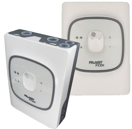
*FAAST FLEX ist einfach und zeitsparend zu installieren; 1-Mann-Installation mit einer Installationsschablone, verschiedene Ausrichtungen, direkte Wandmontage und ausreichend Platz für die Verkabelung. Durch die modulare Bauweise und die vor Ort austauschbaren Komponenten ermöglicht FAAST FLEX eine bequeme Wartung vor Ort, wodurch Ausfallzeiten minimiert und laufende Wartungskosten gesenkt werden.*
