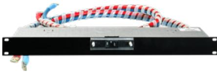
Das Lasttrennfeld für das Sprachalarmsystem INTEVIO dient zum Anschluss der Akkus an die INTEVIO Notstromversorgung 581726. Die Baugruppe ist in einem 19" Gehäuse mit einer Höheneinheit untergebracht. Sie beinhaltet die Sicherungen der Akkuanschlüsse, einen Lasttrennschalter mit dem die Akkus bei Bedarf sicher vom System getrennt werden können und die Akkuanschlusskabel.
