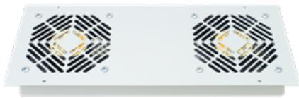
Lüfterkassette für den Dacheinbau in einen Standschrank, zur Steigerung der Wärmeabfuhr. Die Lüfterkassette verfügt über zwei leistungsstarke Lüfter mit Thermostat. In Technikräumen mit einer hohen Staubbelastung wird empfohlen, je nach Typs des Standschrankes, zusammen mit der Lüfterkassette den Filteraufsatz Art.-Nr. 584947 oder Art.-Nr. 584948 zu verwenden.
