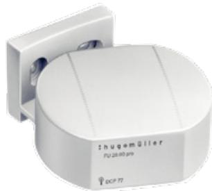
DCF77-Funkempfänger zum Anschluss an die Hauptuhr (Art.-Nr. 583390). Es können bis zu 10 Hauptuhren parallel angeschlossen werden. Das DCF77-Signal wird von Mainflingen (bei Frankfurt am Main) aus gesendet. Die Reichweite des Signals beträgt unter normalen Bedingungen für den Empfänger FU 20.00 pro ca. 1500 Kilometer.
