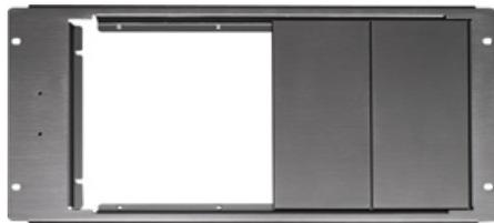
Blindplatte im VARIODYN ONE Design, für den Einbau einer Ethernet Touch Callstation ETCS als zentrales Bedienfeld in einen 19" Standschrank oder einer digitalen Sprechstelle DCS plus. Bitte beachten Sie, dass über dieser Blindplatte noch eine Blindplatte mit mindestens 1 HE positioniert werden muss, damit ausreichend Anschlussplatz für den Anschluss der eingebauten Sprechstelle zur Verfügung steht.
