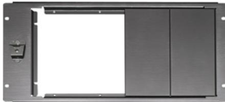
Blindplatte 5HE im VARIODYN ONE Design, für den Einbau einer Ethernet Touch Callstation ETCS als zentrales Bedienfeld, oder eine Sprechstelle DCS plus in einen 19" Standschrank, zusammen mit einem Tastenerweiterungsmodul DKM plus. Bitte beachten Sie, dass über dieser Blindplatte noch eine Blindplatte mit mindestens 1 HE positioniert werden muss, damit ausreichend Anschlussplatz für den Anschluss der eingebauten Sprechstelle zur Verfügung steht.
