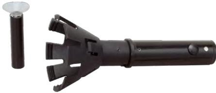
Zur Entnahme der Brandmelder der Serie 9x00 sowie IQ8Quad. Durch die optionale Adaption eines Saugnapfes in die vorgesehene Einführung am Entnahmewerkzeug können zusätzlich die Melderabdeckkappen Art.-Nr. 805588 und 805589 von den Brandmeldern IQ8Quad und der Sockelabdeckung für IQ8Quad Art.-Nr. 805587 abgezogen werden. Das Melderentnahmewerkzeug kann an die Teleskopstangen Art.-Nr. 060426 und 060247 sowie mit 805581 an 769813 adaptiert werden.
