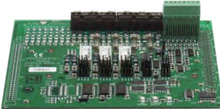
Das Peripheriemodul enthält ein Feuerwehrbedienfeldinterface sowie ein ÜE-Interface und drei frei programmierbare, wahlweise überwachte oder bis 30 V DC potenzialfreie Sammelrelais. Das Peripheriemodul kann ausschließlich auf dem Systemstecker 1 des Interfaceboards der Zentrale verwendet werden.
