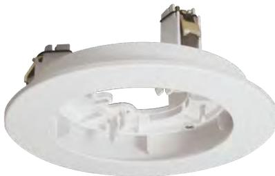
Das uP-Gehäuse für IQ8Quad Meldersockel wird zum Einbau des IQ8Quad Melders in abgehängte Decken eingesetzt oder dort, wo eine verdeckte Montage des Meldersockels (Art.-Nr. 805590, 805591) erforderlich ist. Der Meldersockel zur Aufnahme des IQ8Quad Melders wird in das uP-Gehäuse eingerastet und durch den aufgesetzten Abdeckring nach Außen hin optisch abgeschlossen. Der Meldersockel ist somit nicht mehr sichtbar.
