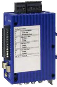
Vorbereitet für Hutschienenmontage. Schnittstellenwandler elektrisch/optisch für RS 485 Feldbus-netze; Repeaterfunktion; für Quarzglas-LWL; elektrischer Vollduplex- oder Halbduplex-Betrieb; Langstreckenversion.
