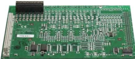
Das Erweiterungsmodul wird auf das Interfaceboard der Zentrale gesteckt. Das Erweiterungsmodul kann ausschließlich auf den Systemstecker 1 des Interfaceboards der Zentrale verwendet werden.
