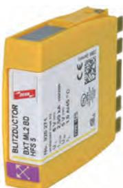
Platzsparendes Kombi-Ableiter-Modul mit LifeCheck zum Schutz von einer Doppelader hochfrequenter Bussysteme, wahlweise direkte oder indirekte Schirmerdung.
