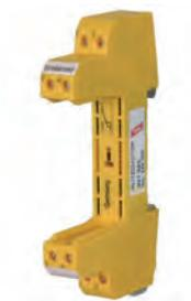
Basisteil als sehr platzsparende, 4-polige, universelle Durchgangsklemme zur Aufnahme des Ableiter-Moduls ohne Signalunterbrechung. Die sichere Erdung des Ableiter-Moduls wird über den Hutschienen-Tragfuß mittels Schnappbefestigung hergestellt. Da sich keinerlei Bauelemente der Schutzschaltung im Basisteil befinden, beschränken sich Wartungsarbeiten auf die Schutzmodule.
