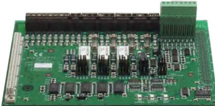
Wie 772479, jedoch mit einem zusätzlichen Steckplatz für Mikromodule. Das Peripheriemodul kann ausschließlich auf dem Systemstecker 1 des Interfaceboards der Zentrale verwendet werden.
