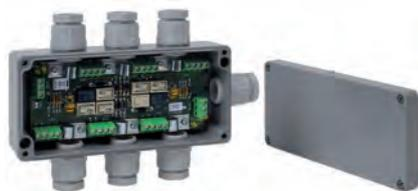
Der essernet®-Umschalter ermöglicht die unterbrechungsfreie redundante Umschaltung zwischen einer Haupt- und Reserveleitung bei Störung der essernet®-Datenleitung. Die Spannungsversorgung des Umschalters erfolgt über die Brandmelderzentrale.
