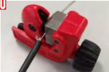
Wird empfohlen für das Schneiden des Edelstahlrohrs, um die Ummantelung zu entfernen und Spleißung des pigtails bis zum Sensorkabel zu ermöglichen.
