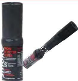
Smokesabre ist Prüfgas und Prüfgerät in einem. Das Prüfgas wird durch das ausziehbare Rohr, das auch zur Erhöhung der Reichweite dient, zum Melder geführt. Erleichtert die Auslösung der Rauchmelder in schwer zugänglichen Räumen, wie z.B. Zwischendecken/Böden und ist auch bei niedrigen Deckenhöhen anwendbar.
