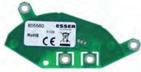
In Brandmeldeanlagen, in denen eine hohe EMV-Belastung (z. B. durch Leuchtstoffröhren oder elektrische Steuergeräte) zu erwarten ist, sollte der EMV-Baustein in den Standard-Meldersockel (Art.-Nr. 805590) der entsprechenden Brandmelder eingebaut werden.
