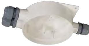
Der Feuchtraum-Sockeladapter wurde speziell für die aP-Kabelzuführung durch Kabelschutzrohre konzipiert und verfügt über drei Eingänge mit 20 mm Durchmesser.
