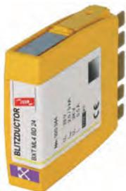
Überspannungs-Schutzmodul als 4-poliges Reiheneinbaugerät. Platzsparendes Kombi-Ableiter-Modul zum Schutz von 2 Doppeladern symmetrischer Schnittstellen mit galvanischer Trennung.
